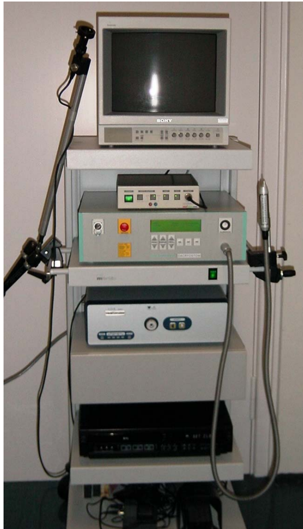
Abbildung 3.1: Endoskopie-System EndoGnost® der Firma Schwind
