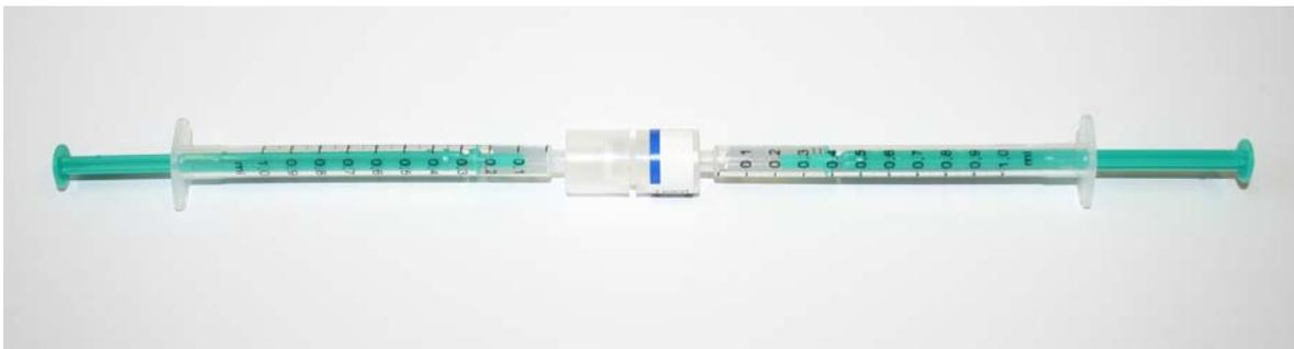
Abb. 2-32: Versuchsaufbau zur Abspaltung der SEM-Schutzgruppen an der Festphase.
