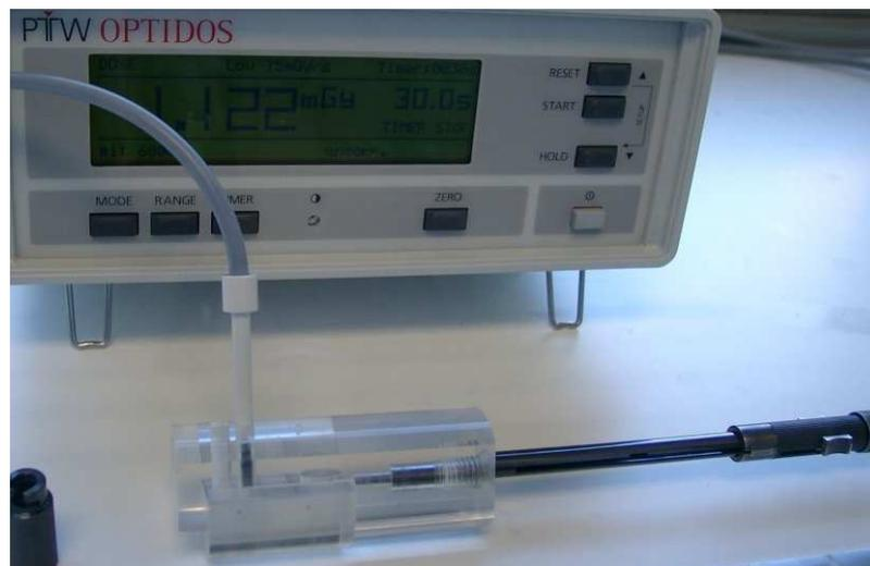
**Abb. 6.15:** OPTIDOS<sup>®</sup> mit Adapter und Spiralenapplikator für die Überprüfung der Aktivität im sterilen Operationssaal.
