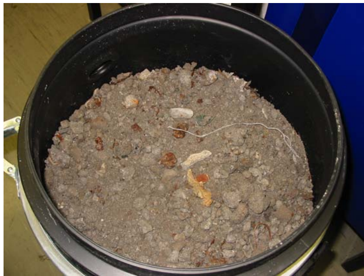
Abb.3: Makroskopisches Erscheinungsbild von Schlacke aus der Müllverbrennung, Durchmesser des Behälters 40 cm
