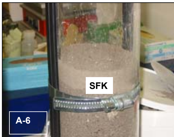
Abb. A-6: Schlacke-Feinkorn (SFK) als Sperrschicht (links)
