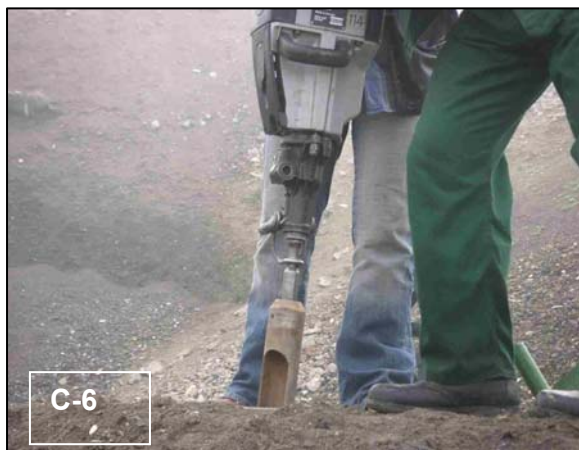
Abb. C-6: Probennahme mittels motorbetriebenen Rammkernbohrgerät (links)
