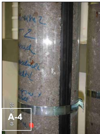
Abb. A-4: Profiltringe und Klemmen, welche die beiden Plexiglashälften dicht zusammenhalten (links)
