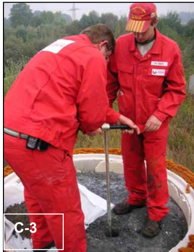
Abb. C-3: Durchführung der ersten Bohrkampagne (BK I) mittels Handbohrer (links)
