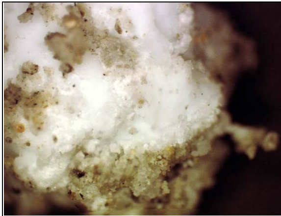
Abb.C-1a: Weiße Salzphase aus einer Bohrtiefe von 5,5 m (BA 1-13), Vergrößerung 20-fach
