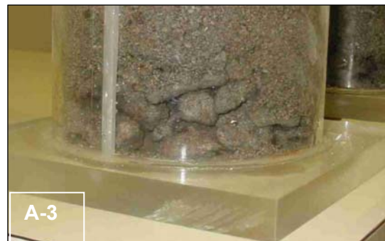
Abb. A-2: Abflussrohre für das Sickerwasser in 1 Liter PE-Auffanggefäße (links) Abb. A-3: Grobes Material an der Basis der Säule (rechts)
