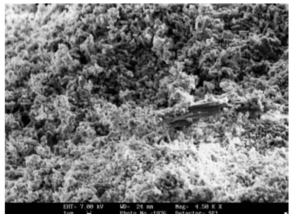
Abb.C-2b: Weiße Salzphase aus einer Bohrtiefe von 6,5 m (BA 1-14), Vergrößerung 1.000-fach
