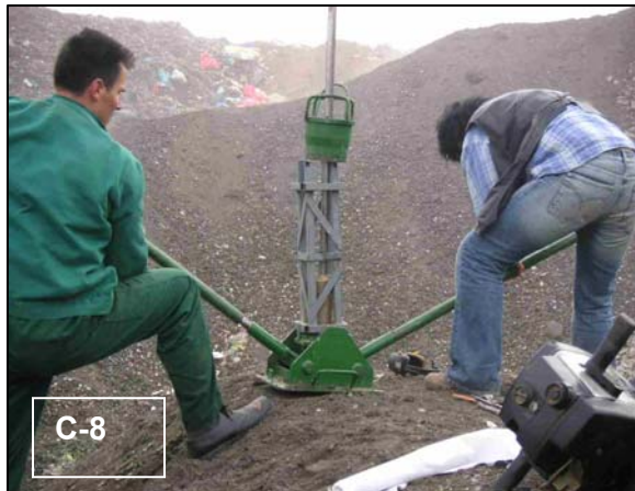
Abb. C-8: Ziehen des Rammkerns durch Hebelwirkung (links)
