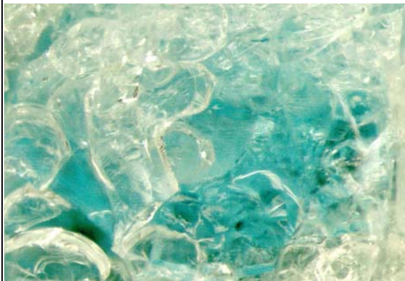
Abb.B-2a: Türkise Salzphase der Schlacke A, Vergrößerung 25-fach
