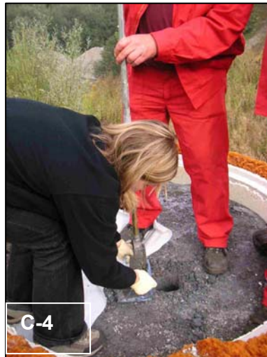
Abb. C-3: Durchführung der ersten Bohrkampagne (BK I) mittels Handbohrer (links)
