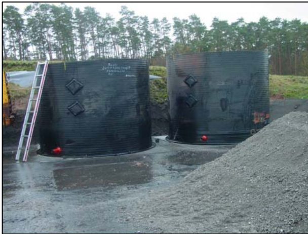
Abb. B-13: Großlysimeter Raindorf, bestehend aus Kunststoffzylindern
