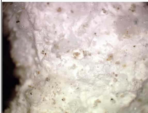
Abb.C-2a: Weiße Salzphase aus einer Bohrtiefe von 6,5 m (BA 1-14), Vergrößerung 12,5-fach
