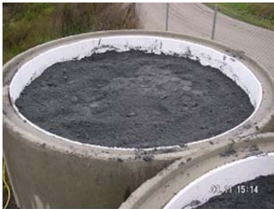
Abb. B-19: 20 cm mächtige RGR-Schicht am Top der Großlysimeter
