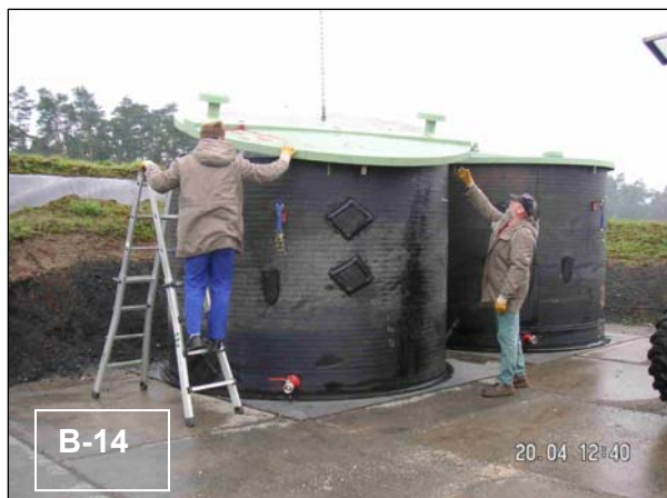
Abb. B-14: Kunststoffdeckel zum Verschließen der Großlysimeter Raindorf (links)
