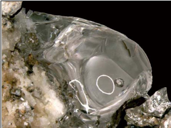
Abb.B-1a: Weiße Salzphase der Schlacke A, Vergrößerung 10-fach
