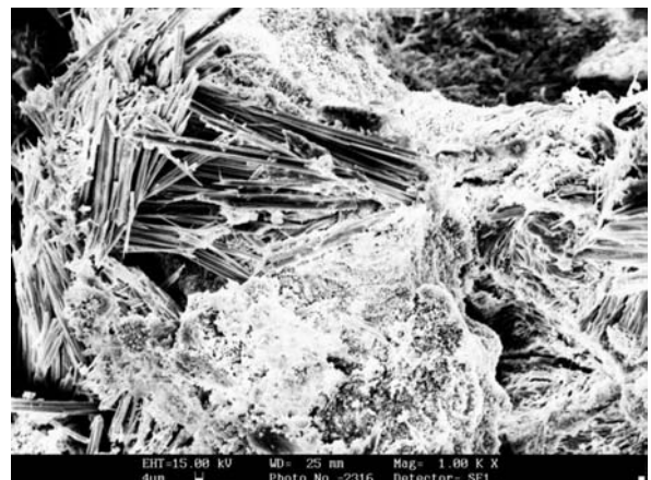
Abb.C-3b: Weiße Salzphase aus einer Bohrtiefe von 7 m (BA 1-15) - Salzhorizont, Vergrößerung 1.000-fach
