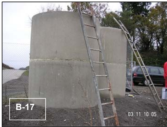
Abb. B-17: Großlysimeter (WA1 und WA2) bestehend aus zwei Betonringen (links)
