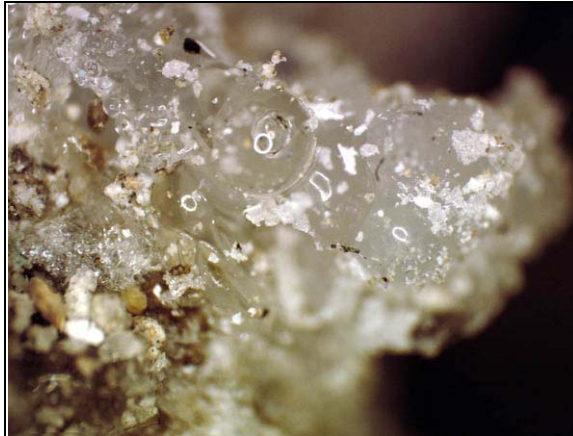
Abb.C-4a: Weiße Salzphase aus einer Bohrtiefe von 8,5 m (BA 1-17), Vergrößerung 20-fach
