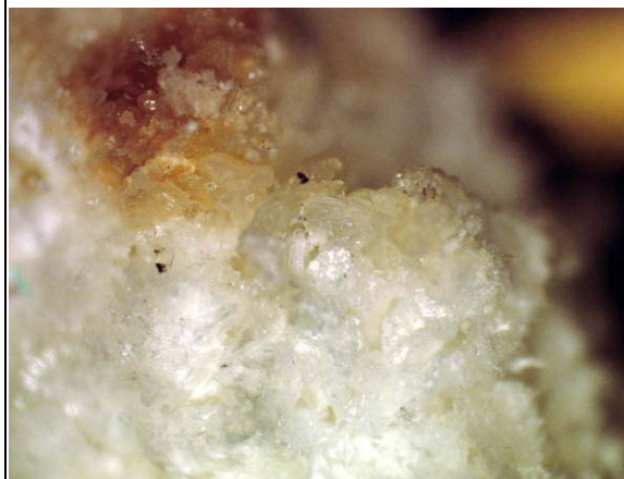
Abb.C-3a: Weiße Salzphase aus einer Bohrtiefe von 7 m (BA 1-15) - Salzhorizont, Vergrößerung 20-fach
