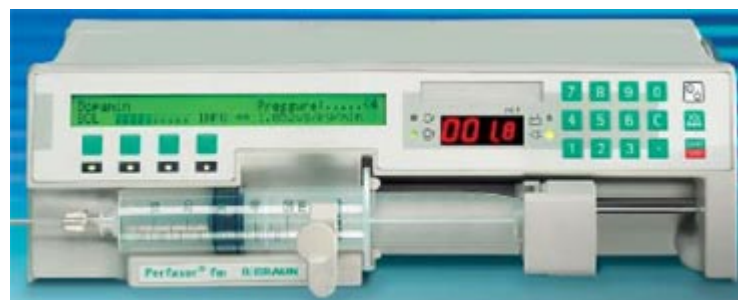
Abb. 5: Perfusor zur konstanten Kontrastmittelapplikation
