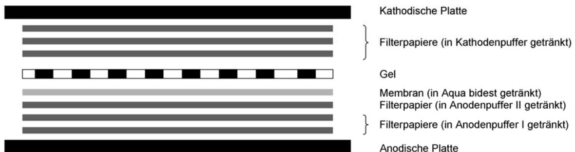
Abb. 3.4.5: Aufbau des Blotsandwiches
