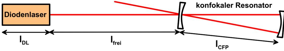
Abbildung 6.6: Schematischer Aufbau zur optischen Stabilisierung eines Diodenlasers auf einen konfokalen Resonator.
