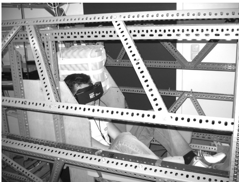
Abbildung 7: Zwei-dimensionaler computergesteuerter Drehstuhl
