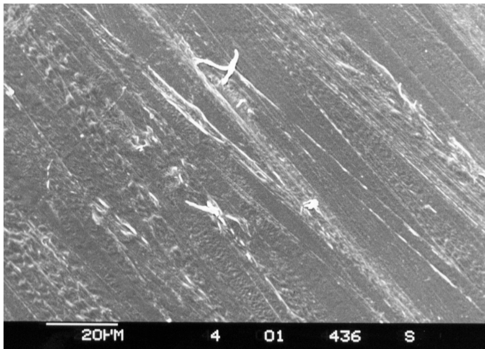
Abb.31: Sanfter, abrasiver Verschleiß des medialen Plateaus bei 3° Valgisierung
