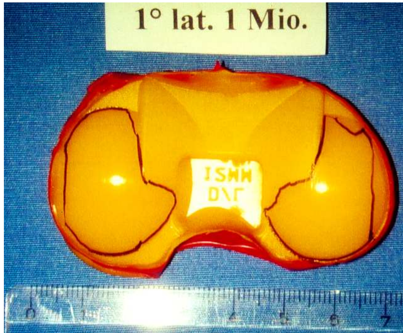
Abb.15: Replika mit umrandeten Tribokontaktzonen
