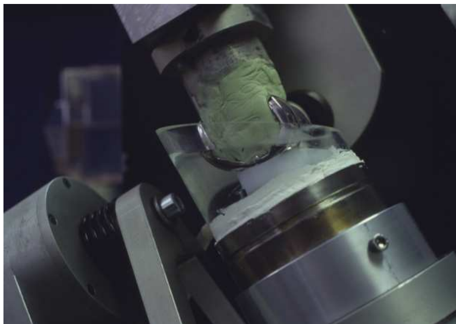
Abb.10: Prothese nach Einbau in den Simulator
