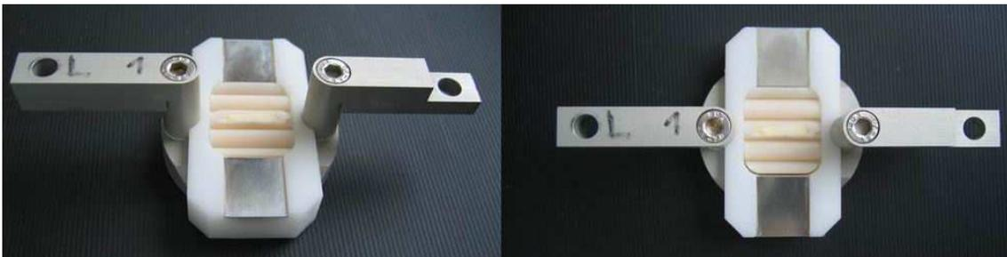
**Abbildung 57: Probenhalter mit verschraubter Probe und fest aufgestecktem Adapter zur Vergrößerung der Bürstenauflagefläche aus zwei Perspektiven**
