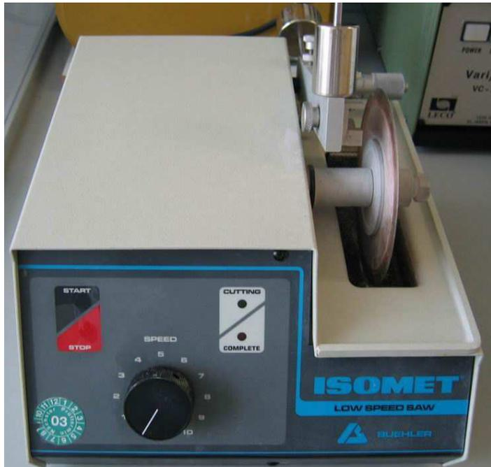
Abbildung 52: Low Speed Saw Isomet
