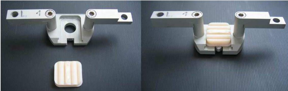
**Abbildung 56: Probenhalter und eingebettete Probe aus zwei Perspektiven; Befestigung erfolgt durch Verschraubung**
