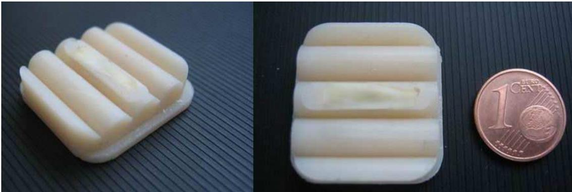
**Abbildung 55: Eingebettete Probe aus zwei Perspektiven im Größenvergleich zu einem Euro-cent-Stück**
