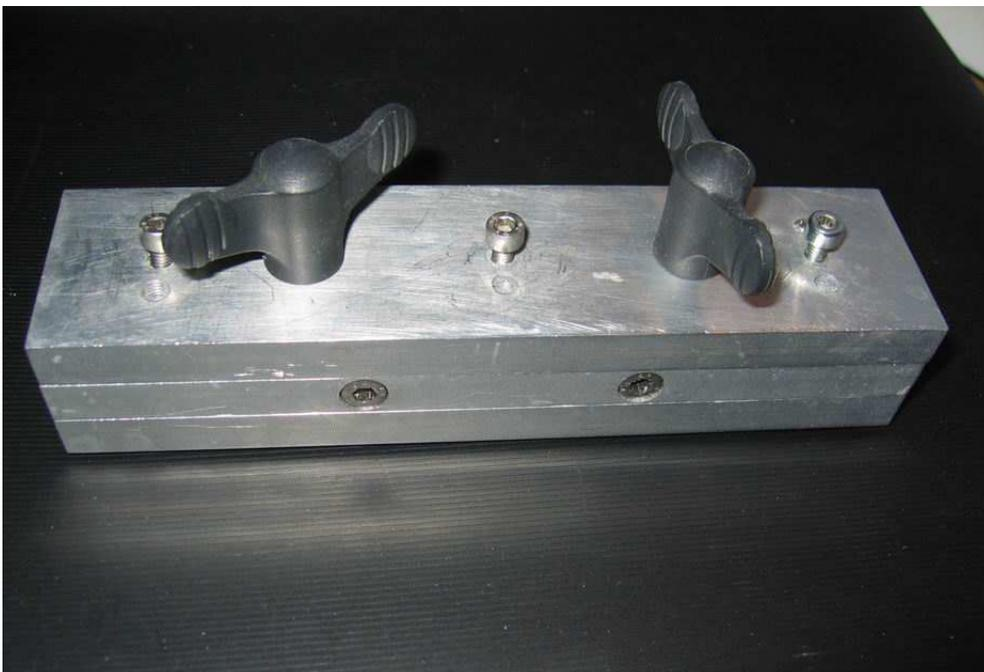
**Abbildung A 9: vollständig zusammengefügte Matrize mit Flügelschrauben montiert und mit Inbusschrauben zur Probenfixierung (Seitenansicht schräg)**
