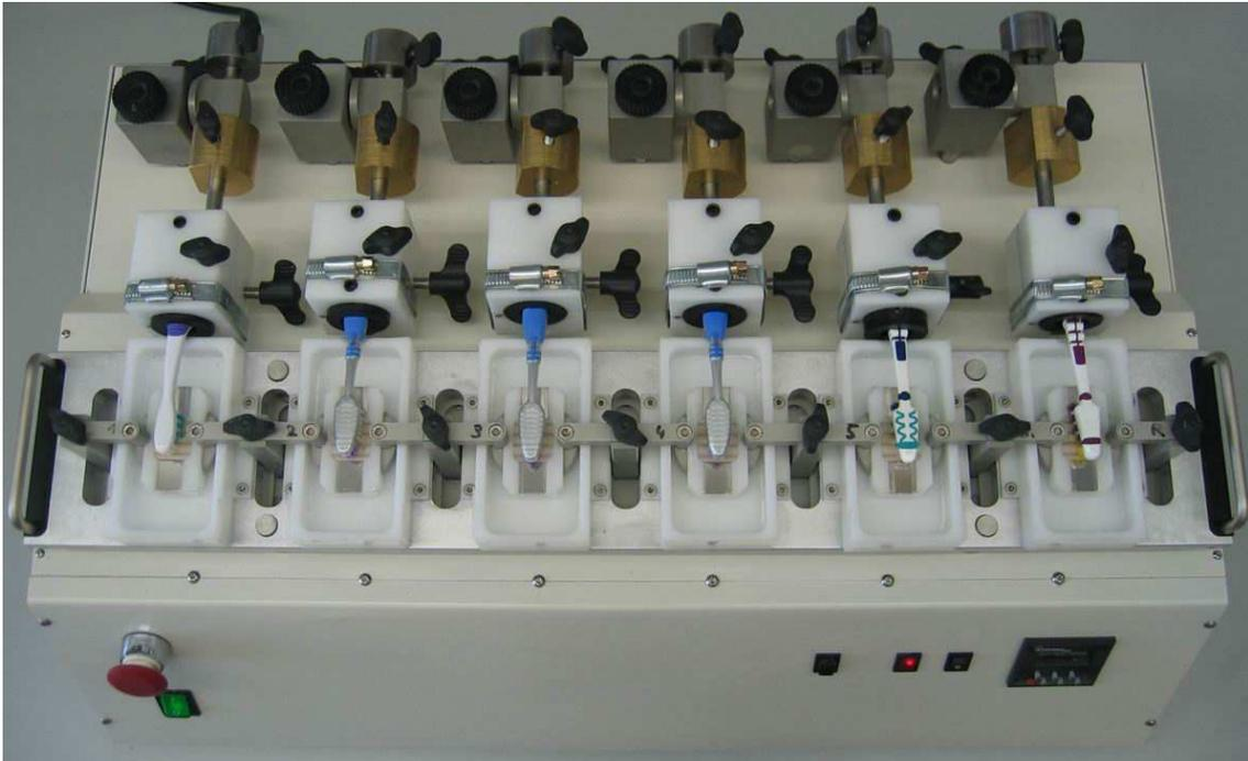
Abbildung 50: Putzmaschine mit 6 eingebauten Bürsten in Sicht von frontal oben
