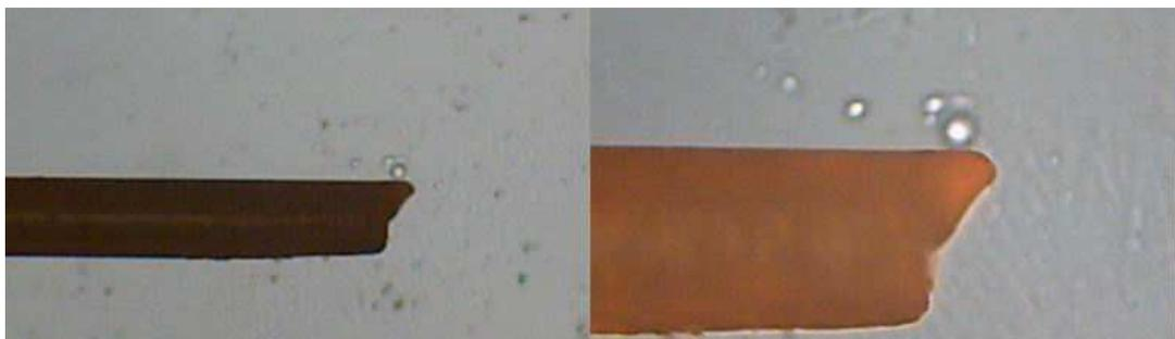
**Abbildung 40: Ende einer (kurzen) weißen Borste der Dr. Best X-Sensorkopf sensitive – Zahnbürste bei 90-facher (links) und 225-facher (rechts) Vergrößerung**
