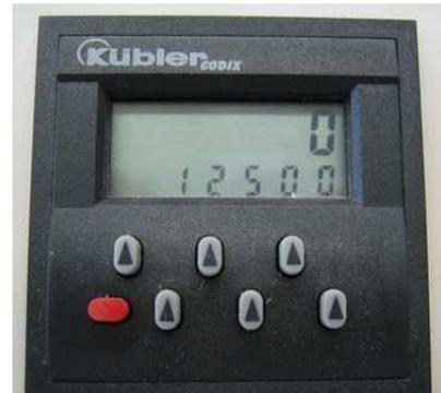
**Abbildung 60: Display mit 12500 eingestellten Putz-Zyklen**
