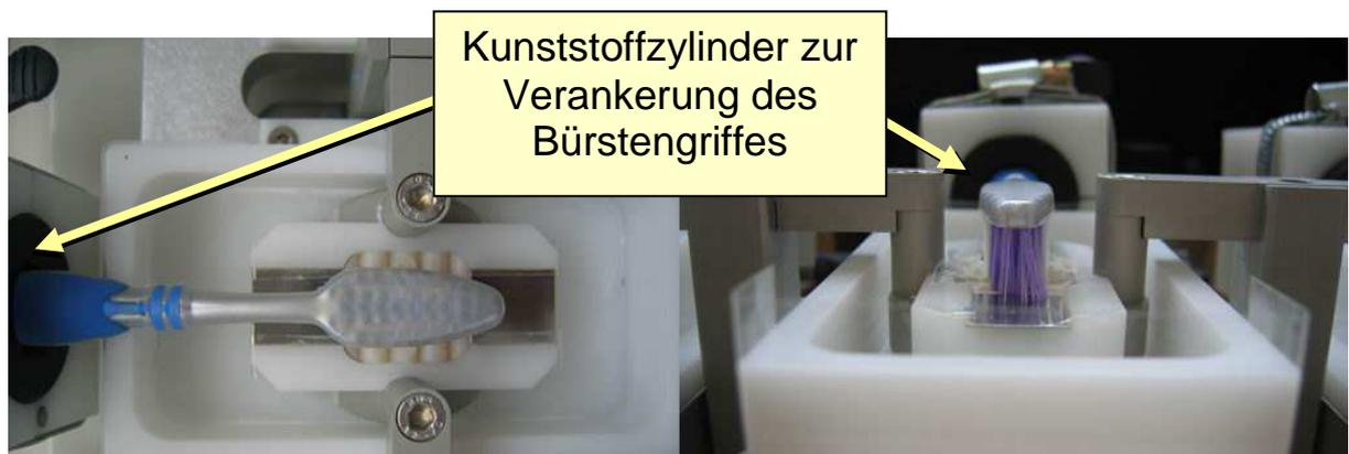
Abbildung A 16: eingebaute Zahnbürste in zwei Ansichten; die Montage erfolgt in einem schwarzen Kunststoffzylinder mit versenkbaren Madenschrauben. Dieser Zylinder wird wiederum in einem weißen teilbaren Kunststoffblock am Putzarm verankert (per Schlauchschelle (wie hier) oder per Verschraubung)
