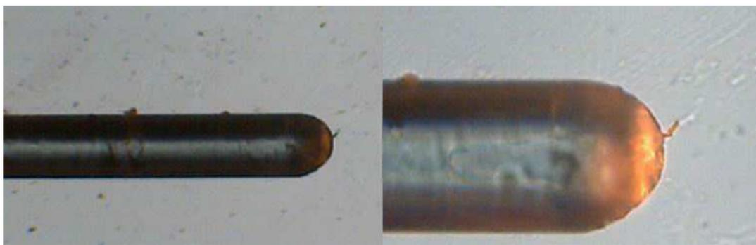
**Abbildung 17: Ende einer kurzen blauen „Indikator“-Borste der Oral B Advantage Plus – Zahnbürste bei 90-facher (links) und 225-facher (rechts) Vergrößerung**
