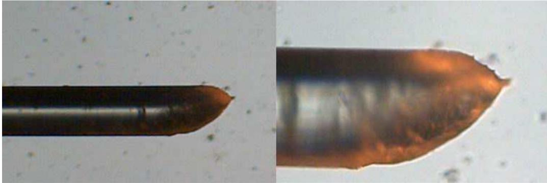
**Abbildung 49: Ende einer Borste der ADA Control – Zahnbürste bei 90-facher (links) und 225-facher (rechts) Vergrößerung**
