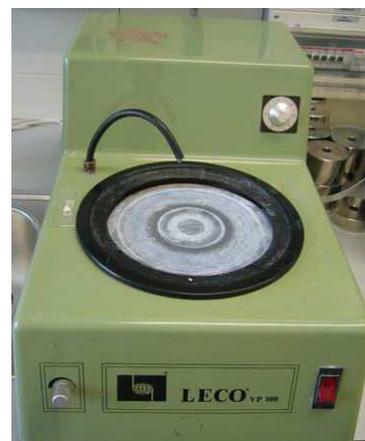
**Abbildung 54: Schleifmaschine Leco VP 100**
