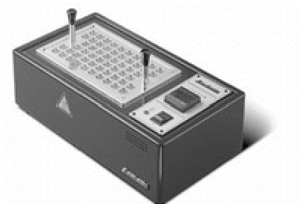
Abbildung II.5: Blockthermostat zur Durchführung nonisothermer Stabilitätsstudien. Im Rahmen dieser Arbeit wurde ein Wärmeblock eingesetzt, dessen Bohrungen dem Durchmesser von 6R-Vials entsprachen.
