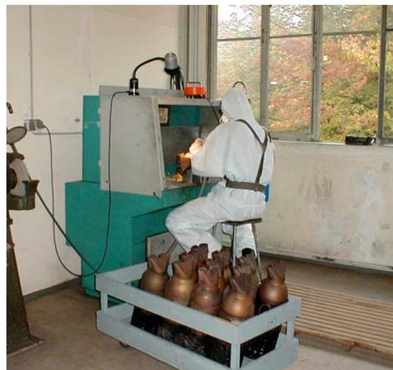
**Bild 13:** Tätigkeit Trockenschleifen 2 im Schleifraum im 2. Obergeschoss
