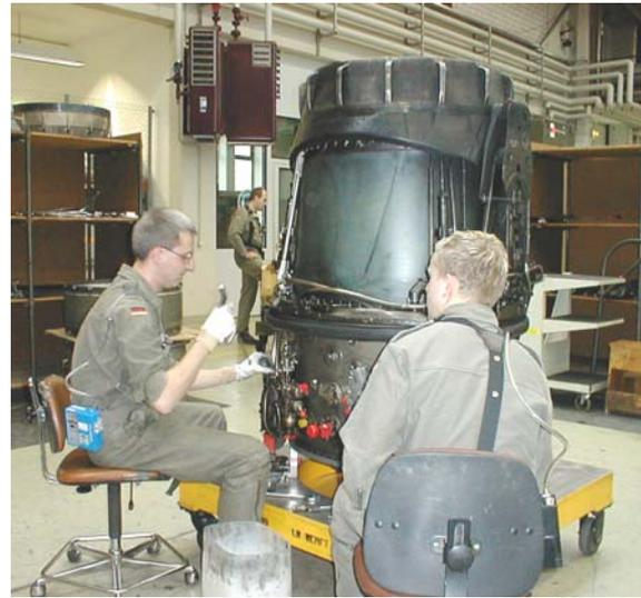
**Bild 4:** Zerlegen eines schmutzigen Nachbrenners
