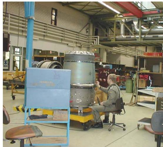
**Bild 2:** Endmontage eines sauberen, instandgesetzten Nachbrenners
