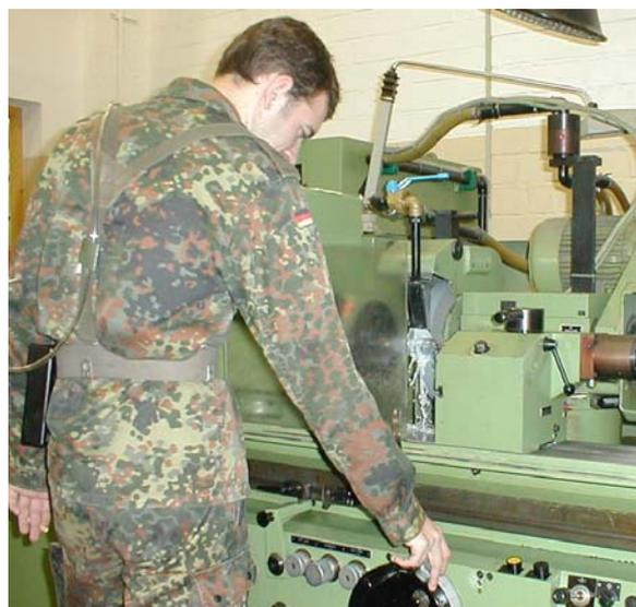
**Bild 9:** Tätigkeit Nassschleifen im Schleifraum 1
