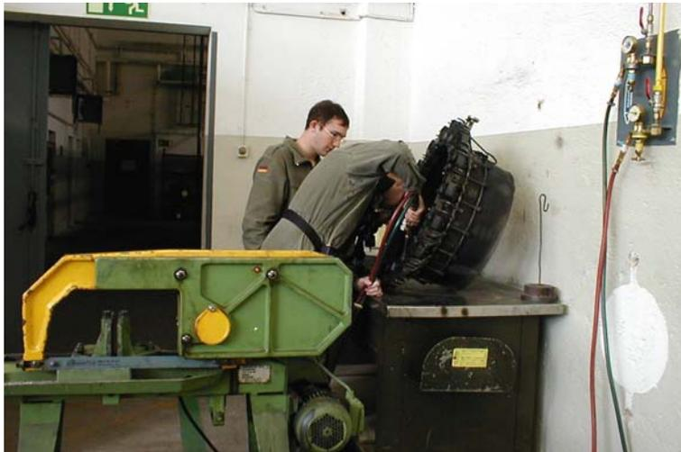
**Bild 5:** Erwärmung von Schraubenverbindungen mit Schweißgerät zum Lösen dieser Verbindungen
