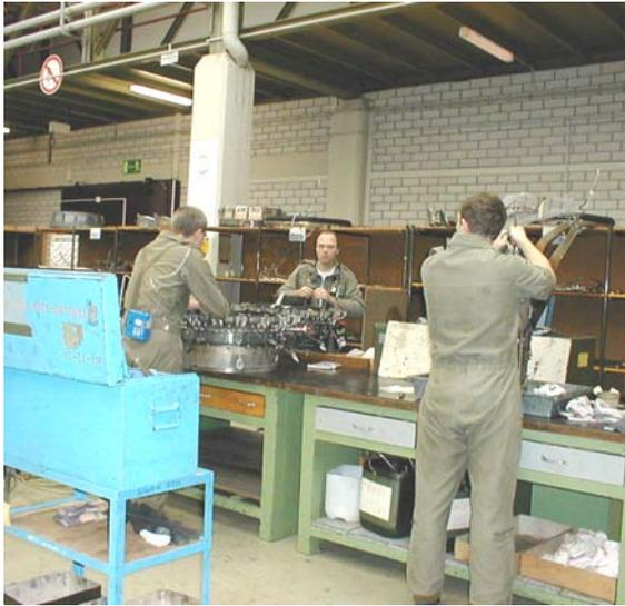
**Bild 3:** Montage des Innenlebens eines Nachbrenners
