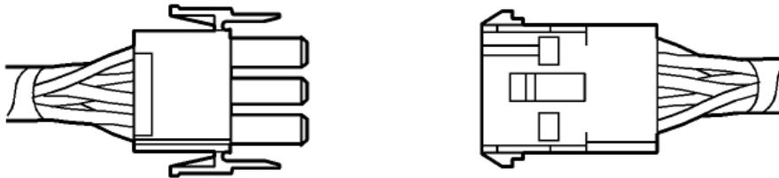
*Abbildung 43: Die verwendeten Steckverbindungen. Links: Stecker; rechts: Kupplung*
