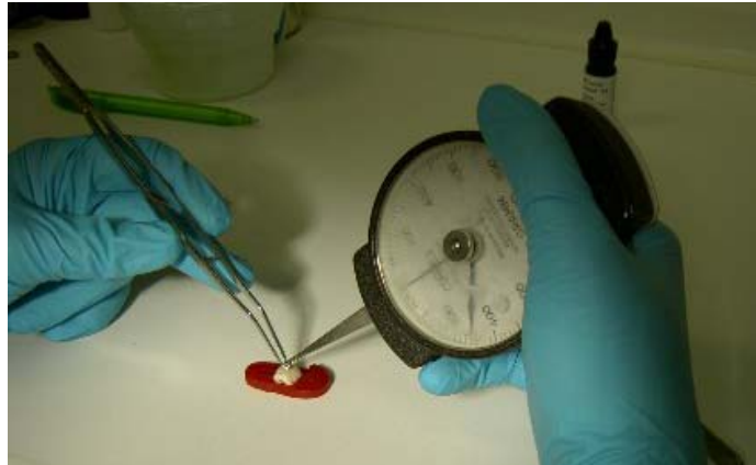
Abb. 7. Ankleben der Brackets mit der Dial-Type Federwaage (Firma Dentaurum)
