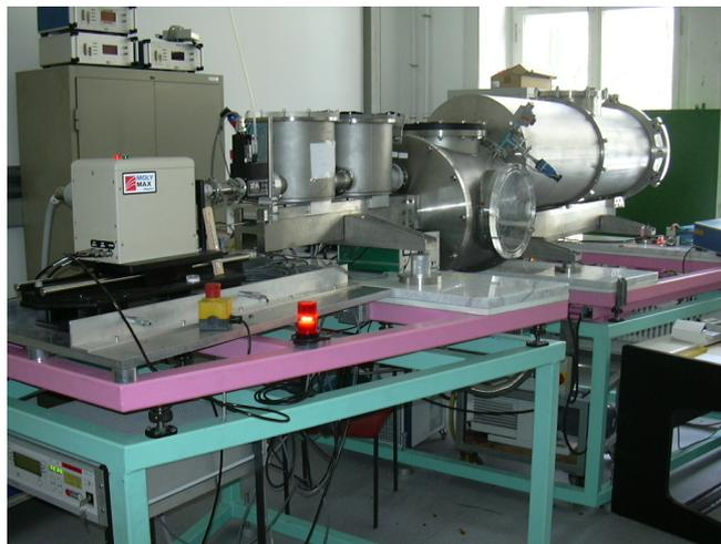
Abbildung 4.1.: Fotografie der Röntgenkleinwinkelapparatur
