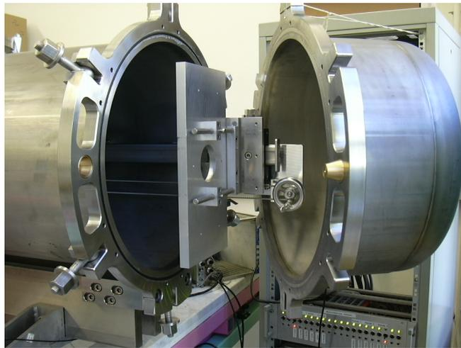
Abbildung 4.7.: Fotografie der Luke am Strahlrohrende mit Bildplattenhalter.
