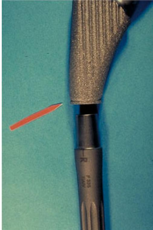
Abbildung 3-5: Konussteckverbindung mit Entlastungsnut
