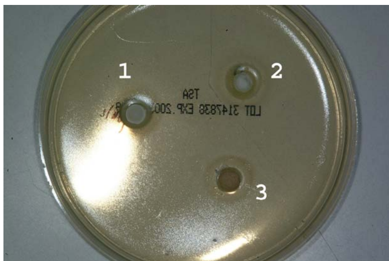
Abb. V 7. Agardiffusionstest für Enterococcus faecalis
