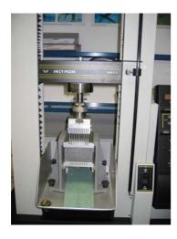
Abbildung 9: Gerät zur Fleischfestigkeitsmessung
