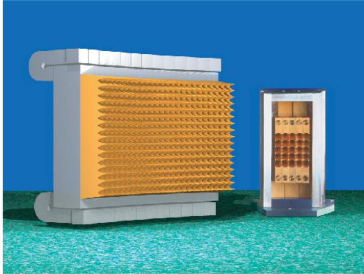
Abbildung 2.6: Vergleich zwischen einer Computersimulation des neuen  $16 \times 25$  und dem früheren *FIFI*  $5 \times 5$  Pixel Detektorarrays (Stacey et al., 1992).
