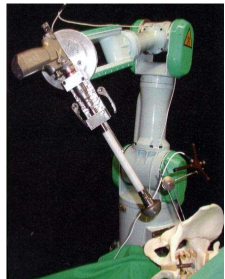
Abb.9: Roboterarm mit Hüftpfannenfräse
