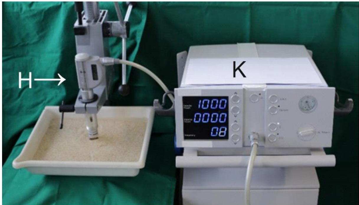
Abbildung 4: Versuchsaufbau der vorliegenden Arbeit. Abkürzungen: G, radiales extrakorporales Stoßwellengerät (Swiss DolorClast Classic; Electro Medical Systems, Nyon Schweiz); H, Handstück; B, Bohrständler; W, Wasserbad, S, Sand. Das gezeigte Foto wurde auch in der Publikation Wu W,... Meindlhumer L , Sternecker K,...Schmitz C. J Orthop Surg Res 2021a;16(1):707 verwendet.
