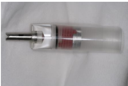
Abbildung 36 Modifikation des Kau-Simulator-Probenhalters(A) und (B): Abgedrehter Kausimulator-Halter mit Nut und Pattern-Resin Adapter; (C) bis (E): \mu CT-Probenhalter mit Adapter und Kausimulator-Halter
