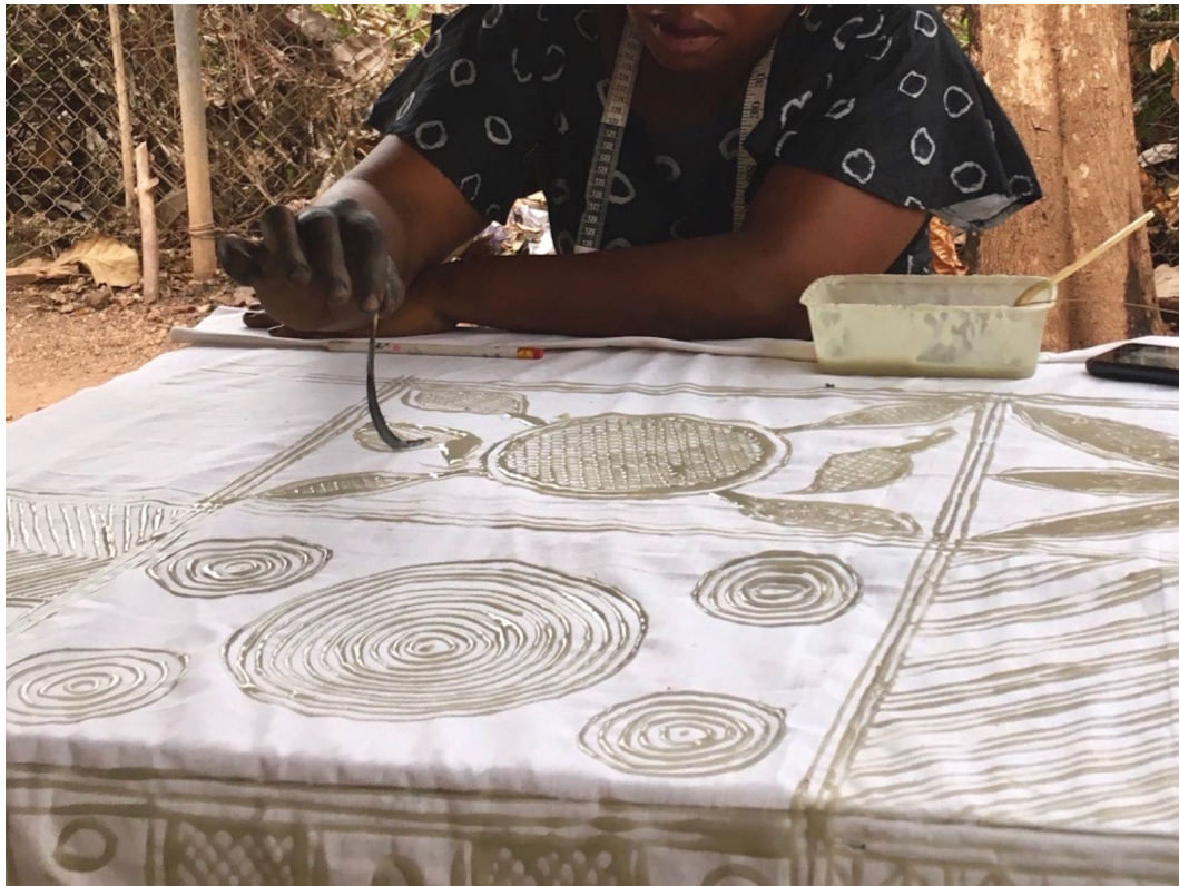
Abb. 7 Adire -Herstellung: Musterauftrag mit Cassava-Paste, Oshogbo, 27.02.2019.
