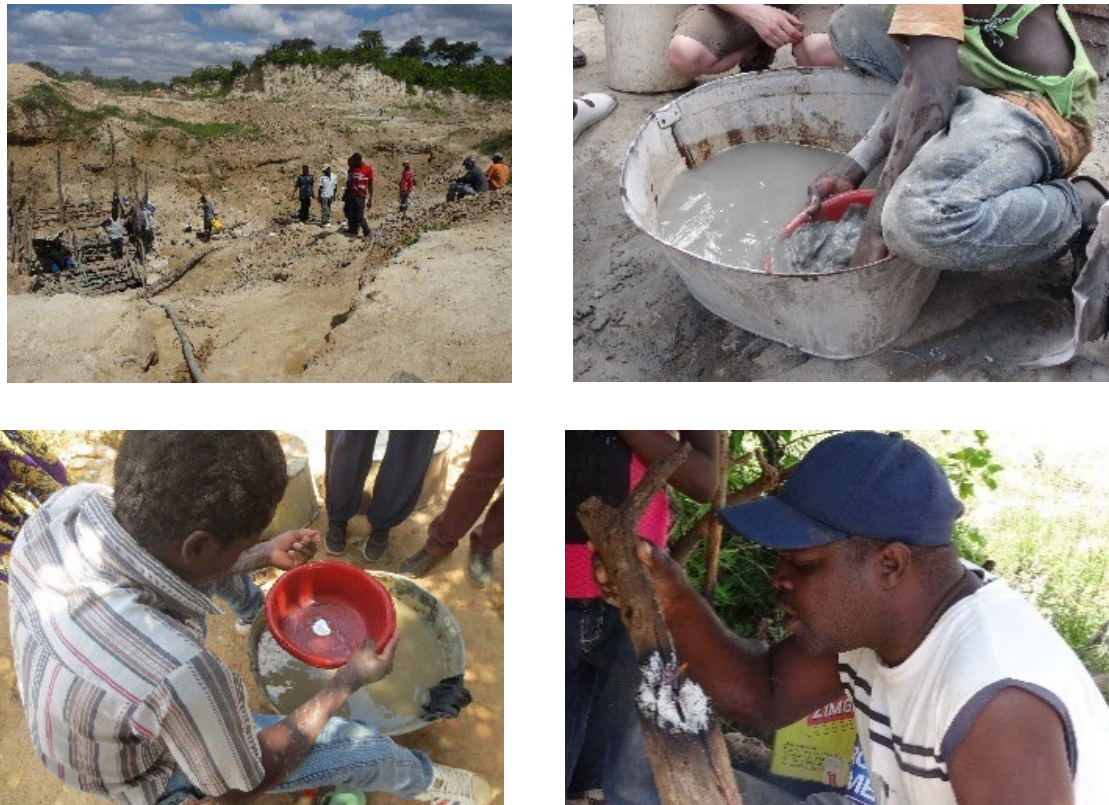
Abbildung 1: Kleinskaliger Goldbergbau in Zimbabwe: Abbau des goldhaltigen Gesteins, Extraktion des Goldes mit Quecksilber, Abtrennung des Amalgams, Verdampfen des Amalgams durch Hitze (von links oben nach rechts unten, Urheberin der Bilder: Viola Mambrey, Institut und Poliklinik für Arbeits-, Sozial- und Umweltmedizin, Klinikum der Ludwig-Maximilians-Universität München).
