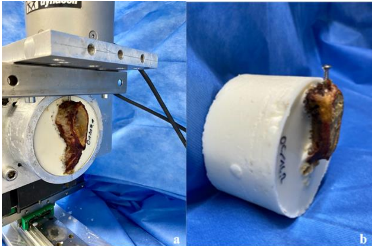
Abbildung 2: Präparat in die Instron-Prüfmaschine eingespannt und montiert während des Prüfzyklus (a), sowie nach dem Schraubenausriß (b). Abbildung entnommen aus: (36)
