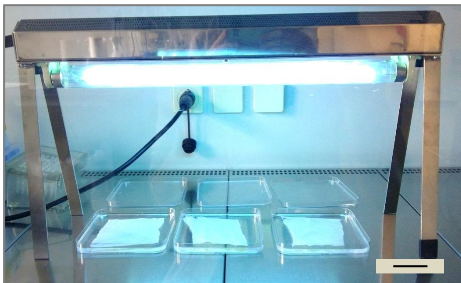
Abbildung 4: Drei 10 x 10 cm große PK-Proben in, mit PBS befüllten, eckigen Petrischalen in einem Abstand von 22 cm unter einer UV-Lampe auf einer Reinraumwerkbank; Maßstabsbalken: 5 cm.
