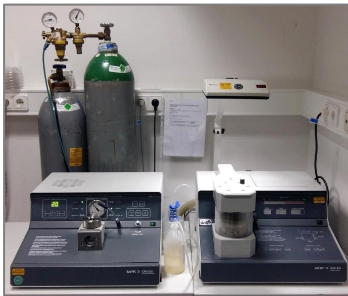
Abbildung 9: Der verwendete Kritisch-Punkt-Trockner CPD 030 links und Sputter-Coater SCD 050 rechts für die Vorbereitung der REM-Proben.
