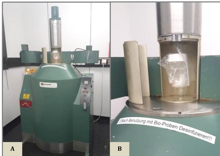
Abbildung 5: Die Bestrahlungsanlage Gammazell 220 (A); Aufhängung der PK-Proben in der Bestrahlungskammer des Gammazell 220 (B).
