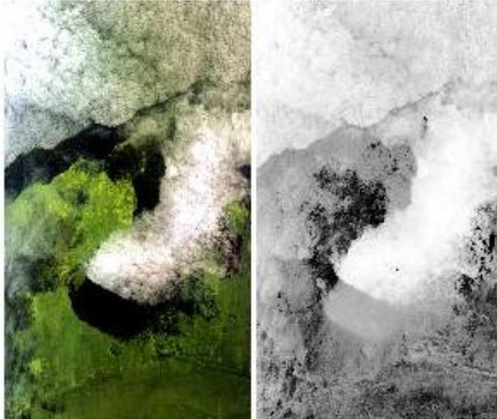
Abbildung 1.1: Messungen des MODIS Airborne Simulator, durchgeführt über Südafrika am 20.8.2000 bei einem Sonnenzenitwinkel von  $47,8^\circ$  (King und Platnick (2006)): Echtfarbenbild (links), Messungen der Helligkeitstemperatur bei  $10,94 \mu\text{m}$  (rechts, hellere Farben stehen für kältere Bereiche).
