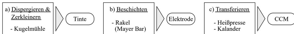
Abb. 2.7: Schematische Darstellung der Prozesskette zur Herstellung einer CCM mittels Membran-basiertem indirekten Ansatz: a) Herstellung einer Katalysatordispersion (Tinte), b) Herstellung einer Elektrode, c) Herstellung einer CCM.
