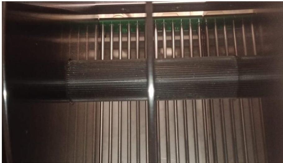
**Abb. 14: Rotarod Walze mit strukturierter Oberfläche.** Das Foto zeigt eine Walze aus dem Rotarod-Gerät, das für die Versuche genutzt wurde. Zu sehen ist die geriffelte Oberflächenstruktur der Walze, die den Versuchstieren möglicherweise ein Festhalten an der Walze erleichterte und so zu längeren Laufzeiten geführt haben könnte (eigene Darstellung).
