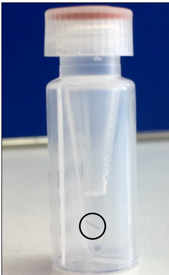
Bild 6: Ein 2 mm-Haarsegment im Vial nach der Extraktion zur Analyse auf Drogen und Medikamente (Extraktionsvolumen 30 µL).
