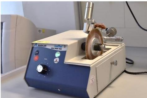
Abbildung 19 IsoMet™ Low Speed Saw Niedertourentrenners (Buehler, Illinois, USA)
