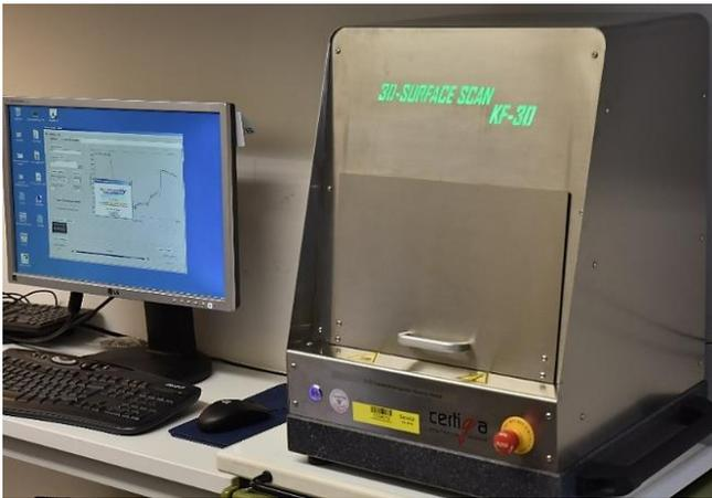
Abbildung 44 3D-Scanner „Oberflächen Scan KF-30“ (Hardware: SyndiCAD, München, Deutschland; Software: Certiga, Unterhaching, Deutschland)
