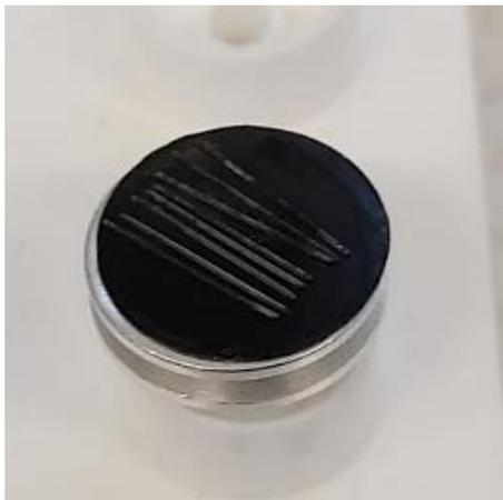
Abbildung 34 Stiftprobenteller mit aufgeklebten Zahnbürstenborsten (helle Striche) vor der Besputterung
