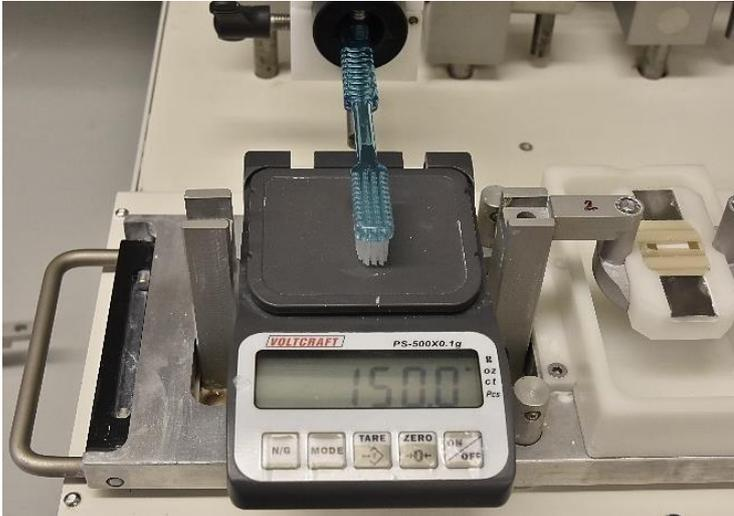
Abbildung 29 Einstellung des Auflagegewichtes von 150 g für jede Zahnbürste
