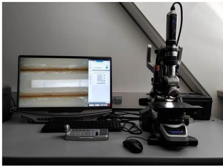
Einschalten des Digitalmikroskops VHX-970F (bestehend aus Mikroskop, Monitor und Konsole)
