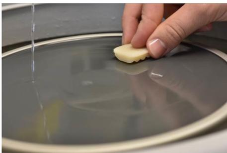
Entformte Probe an der Dentinoberfläche plan schleifen zur Entfernung von Kunststoffüberhängen
