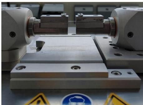
Einbringen der Schraubvorrichtung in das Mikrozuggerät
