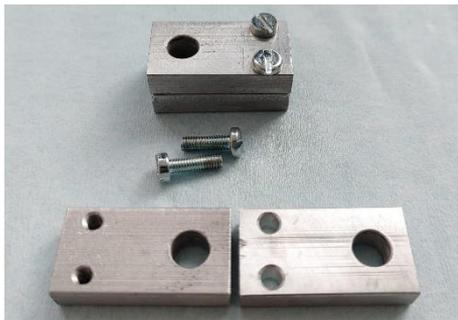
Aufschrauben der Vorrichtung zur Aufnahme einer einzelnen Borste
