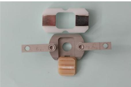
Probe in den Probenhalter der Zahnbürstmaschine einschieben und Abdeckung aufschieben
