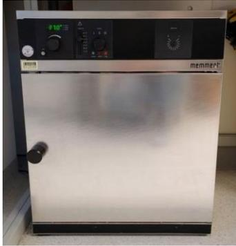
Probe für 24 h im Wärmeschrank in Wasser bei 37° aufbewahren
