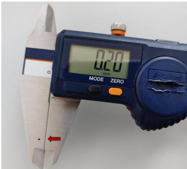
Abbildung 57 Messung des Borstendurchmessers mit der Schieblehre an definierter Position (schwarzer Punkt), siehe roter Pfeil
