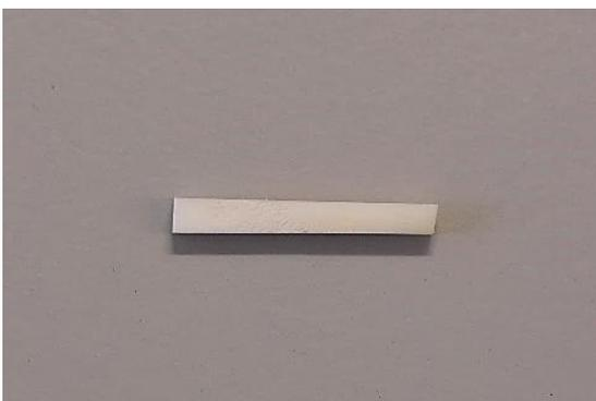
Abbildung 22 Fertig gesägtes Dentinstäbchen mit den Abmessungen 2 mm x 3 mm x mindestens 15 mm
