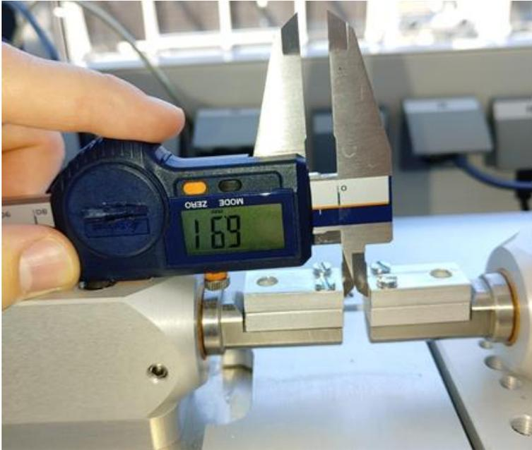
Abbildung 59 Messung der freien Länge eines Filaments mit der Schieblehre
