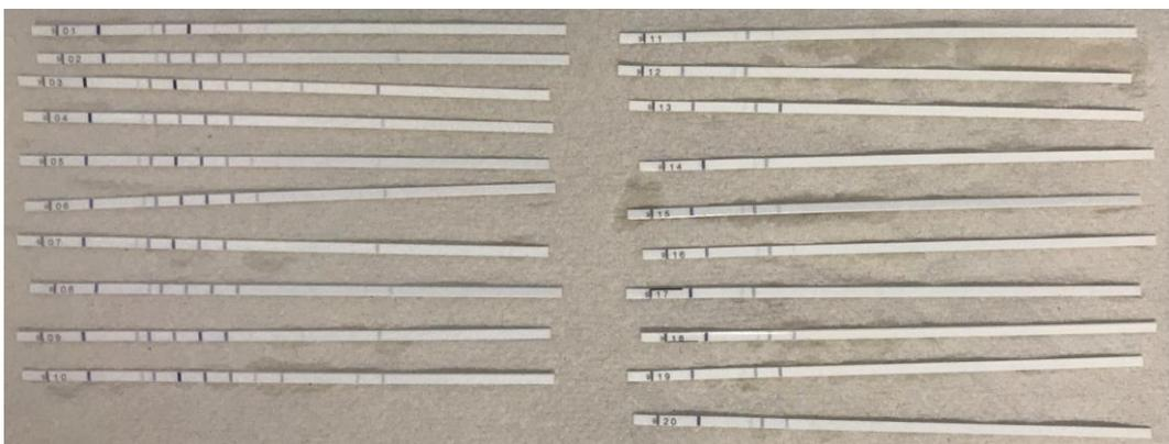
**Abbildung 11: Trocknen der fertigen Streifen auf Zellulosetüchern**
