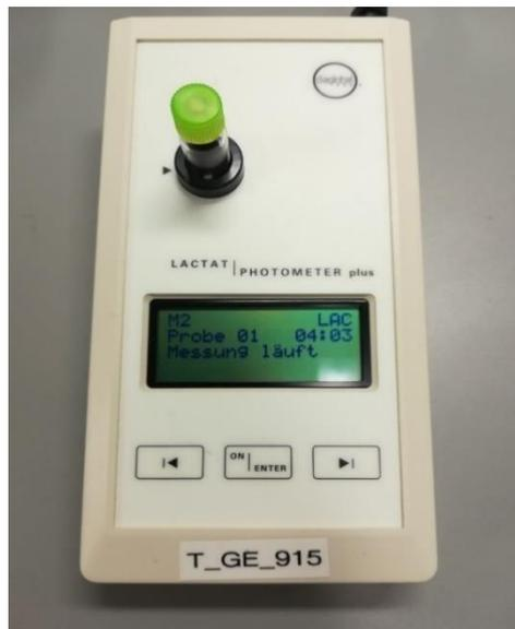
Abb. 4: Küvette im Photometer während einer Lactat-Messung nach Zugabe des Startreagenz
