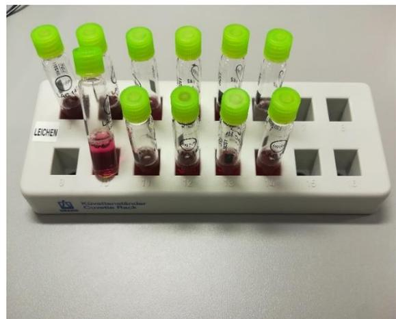
Abb. 5: Aufbau einer Messreihe mittels Diagonal-Küvetten zur Lactat-Bestimmung vor der Reaktion (links) und nach Reaktion mit dem Startreagenz und anschließendem Farbumschlag (rechts)
