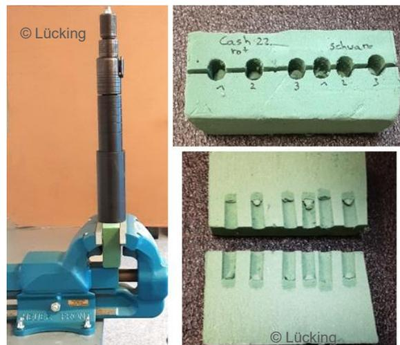
**Abbildung 3.** Messung der Austrittslänge mittels Steckschaum-Methode. Links: Schermer® Typ KR mit Distanzstück auf Blumensteckschaum eingespannt in eine Schraubzwinde; rechts: Schusskanäle im Steckschaum nach Beschuss mit Cash® Typ Magnum Auto .22 unter Verwendung von roter und schwarzer Ladung.
