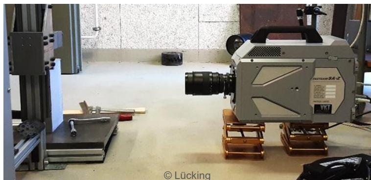
**Abbildung 6.** Hochgeschwindigkeitskamera ausgerichtet auf den Bereich vor der Bolzenmündung (Schussapparat nicht eingespannt) für die Messung der Bolzenaustrittslänge und -geschwindigkeit.
