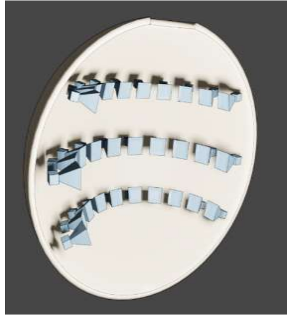
Abb.:59 Schematische Darstellung das senkrecht halbierten Blasenmodells. Oben die Zugangsöffnung, schematisch drei Ebenen der Kamerapositionen mit ihren Blickrichtungen (pyramidenförmig)
