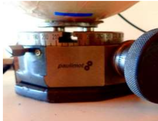
Abb.: 55 Fixierung des Modellfußes Teilapparat mit Magneten
