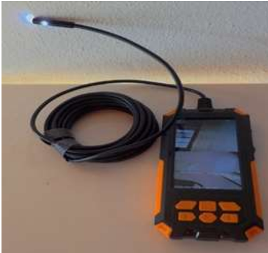
Abb.: 48 Industrieendoskop mit dualer Kamera
