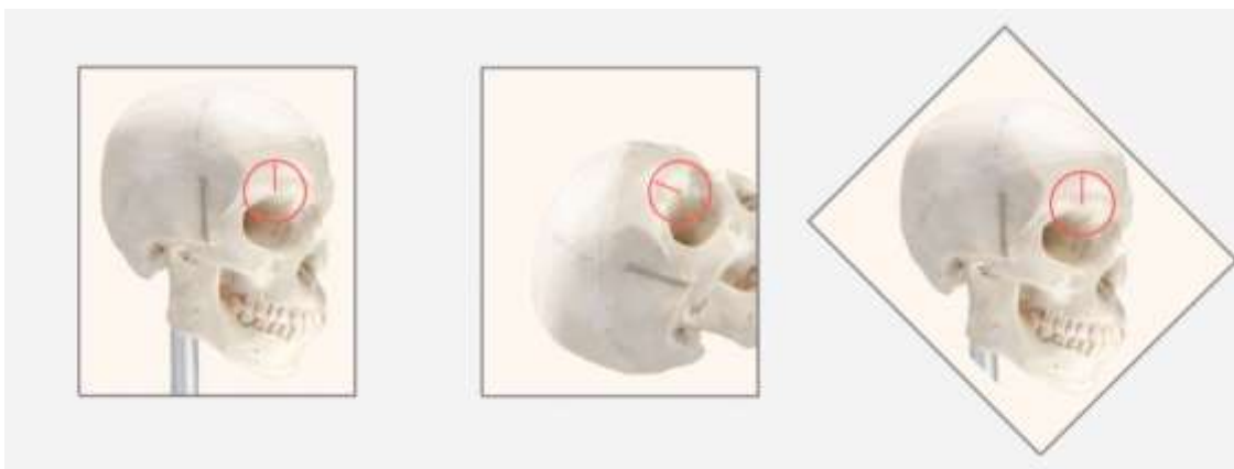
Abb.: 31 Kompensation einer Rotation des Bildhorizonts Modifizierte Darstellung nach D. G. Lowe [119]
