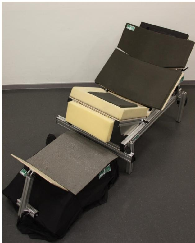
Abb. 4: Winkelverstellbarer Teststuhl Rohversion.
