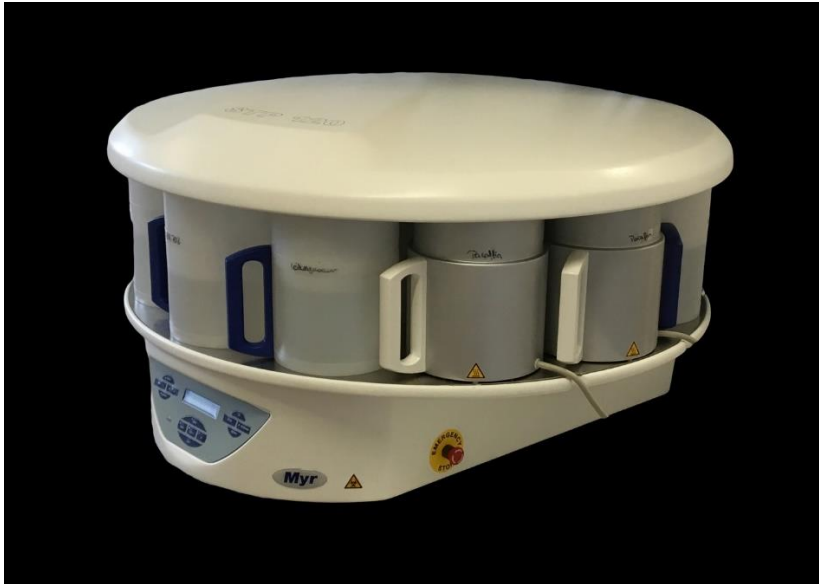
Abbildung 10: Gewebeeinbettautomat Spin Tissue Processor STP 120-2 (Fa. Myr® Especialidades Médicas, S.L. Spanien), Histologisches Labor Klinik für Vögel, Kleinsäuger, Reptilien und Zierfische, Oberschleißheim
