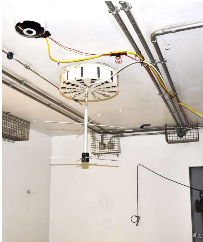
Abbildung 6. Technik-Setup in Voliere: Yagi-Antenne, Überwachungskamera und zusätzliches Mikrofon an der Wand
