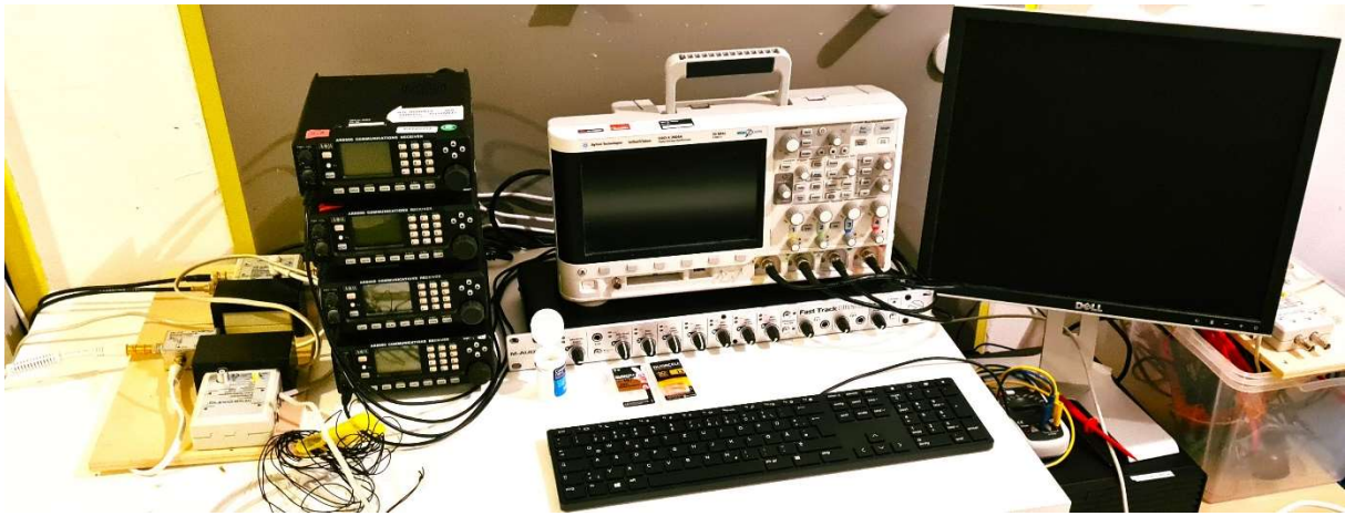
Abbildung 7. Technik-Setup vor der Voliere: Receiver, Audio/MIDI Interface und Oszilloskop sowie Bildschirm zur Aufzeichnung der Tonspuren
