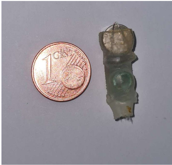
Abbildung 5. Größenvergleich des Miniatur-Mikrofons mit einer 1 Cent-Münze
