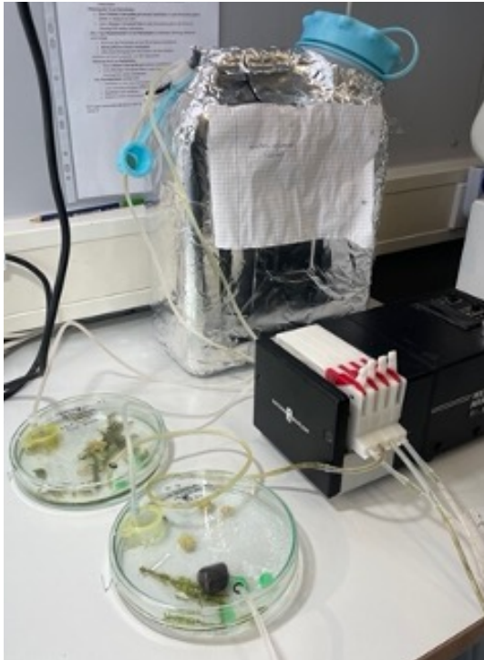
Abbildung 10: Fließsystem in Petrischalen zur Haltung von Zwergschlammschnecken
