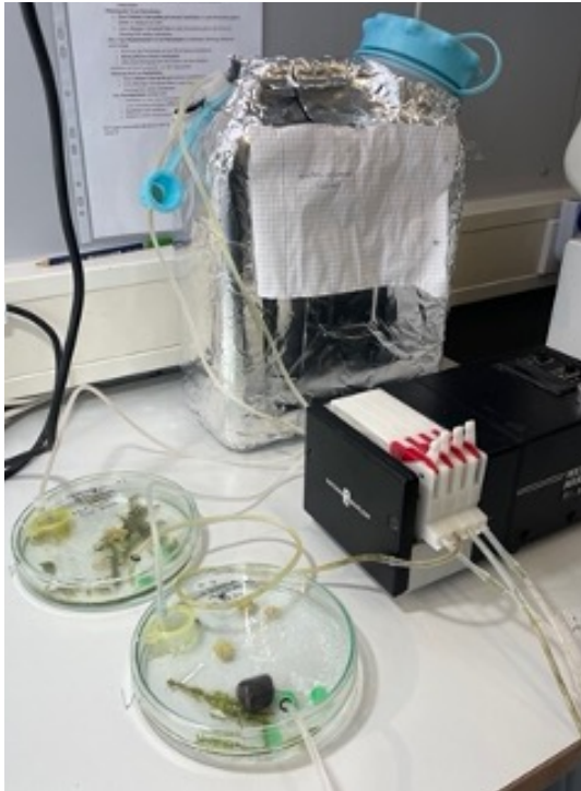
Abbildung 10: Fließsystem in Petrischalen zur Haltung von Zwergschlammschnecken
