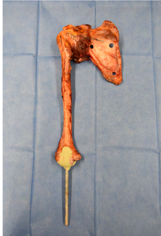
Abbildung 2.7: Fertige Präparation; Zustand nach Zementierung der Gewindestange, Bohrung und Einnähen des ETHIBOND ® EXELS
