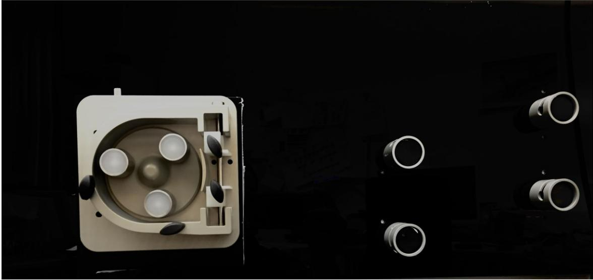
*Abbildung 35 Pumpenkopf mit Magnetventilen*
