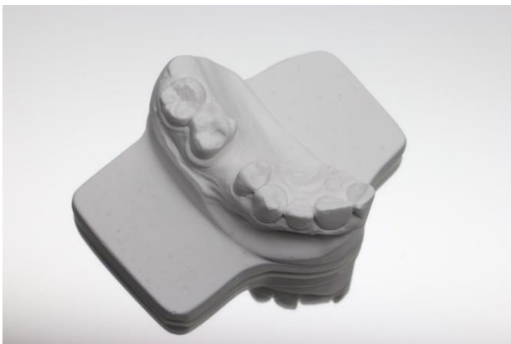
Abbildung 4: Fotografische Darstellung eines fertigen Duplikationsmodells auf Polyurethanbasis für die experimentelle navigierte Implantation. Die oro-vestibuläre Verlängerung der Basis dient der Fixation des Modells auf einem Tisch.
