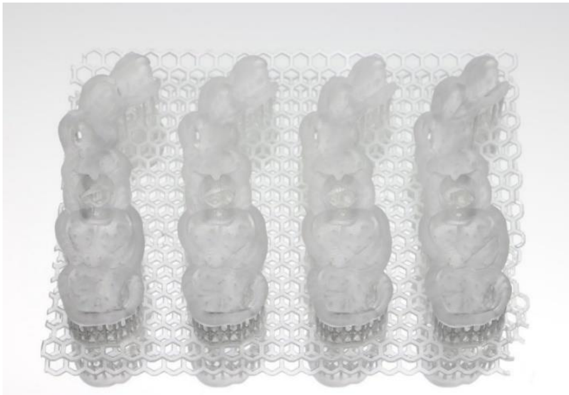
Abbildung 11: Fotografische Darstellung im Rahmen der durchgeführten Studie. 3D-gedruckte, gereinigte und durchgehärtete Bohrschablonen mit Stützstrukturen.
