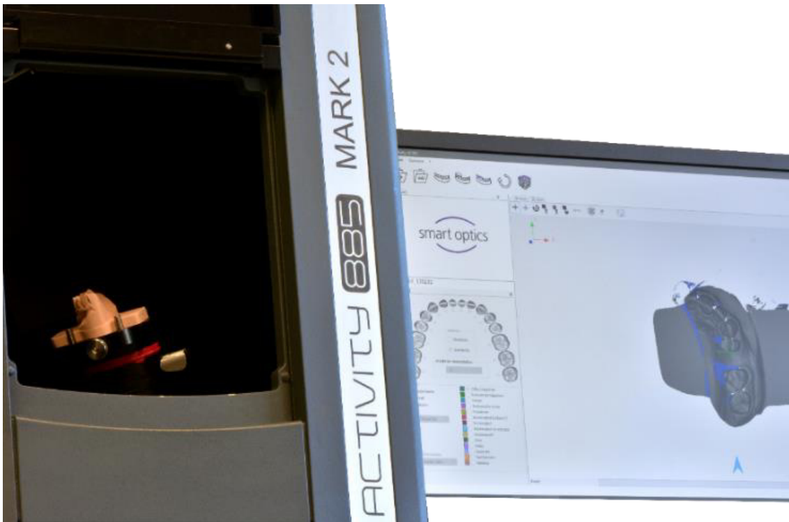
Abbildung 5: Fotografische Darstellung des in dieser Studie verwendeten 3D-Laborscanners Activity 885 Mark 2 (links) mit Duplikationsmodell in Situ und entsprechender Scanner-Software (rechts) (smartoptics).
