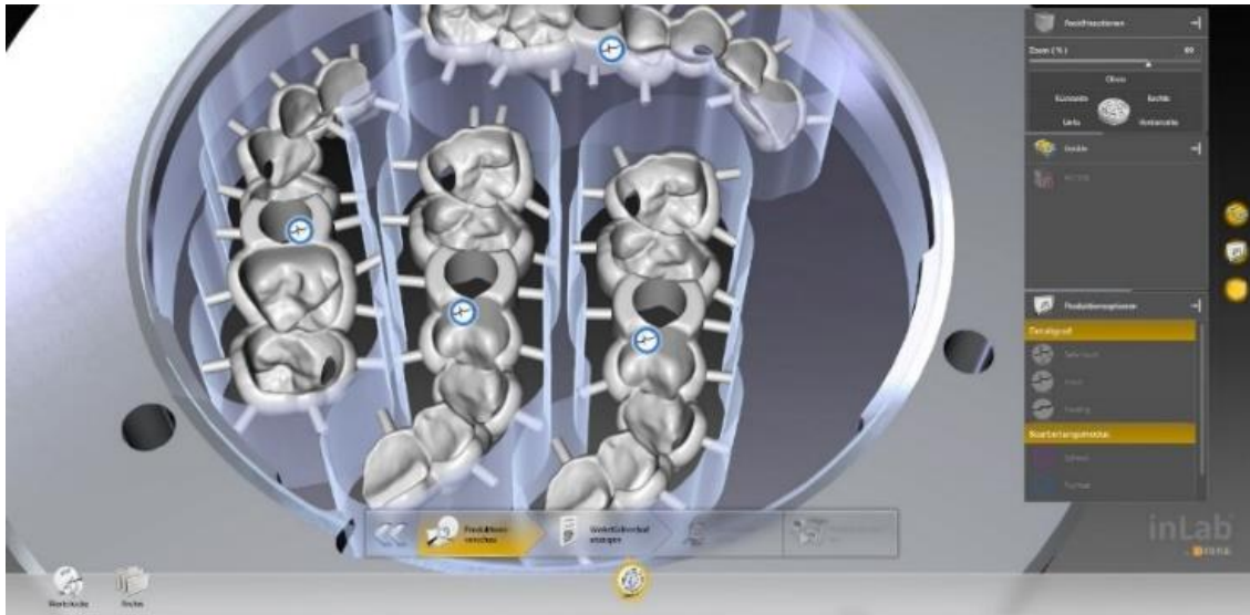
Abbildung 13: Bildschirmaufnahme im Rahmen der Erstellung experimenteller Schablonen in der inLab CAM-Software (Dentsply Sirona). Die genesteten Bohrschablonen sind über Verbinder mit der Materialronde verbunden. Die Ronde ist im Werkstückhalter der 5-Achs-Fräsmaschine befestigt. Die kleinen Kreise (blau) im Bereich der Schablonen zeigen den ausgewählten Detailgrad (hoch) und den Bearbeitungsmodus (normal) an.
