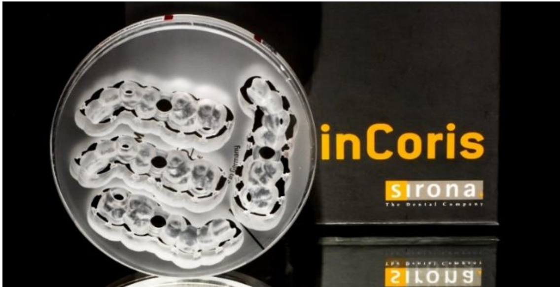
Abbildung 14: Fotografische Darstellung im Rahmen der durchgeführten Studie. Die fertig gefrästen Bohrschablonen sind über Verbinder mit der Materialronde (inCoris PMMA guide, Dentsply Sirona) verbunden.
