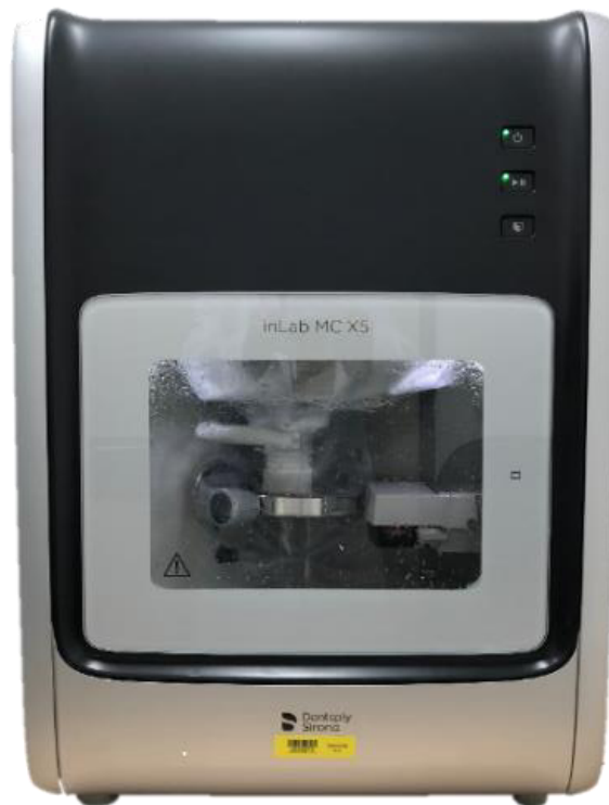
Abbildung 12: Fotografische Darstellung der im Rahmen dieser Studie verwendeten 5-Achs-Fräsmaschine inLab MC X5 (Dentsply Sirona)
