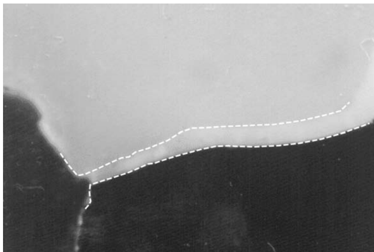
Abb. 4.22: Zementfuge einer IPS Empress-Brücke (Vergrößerung: 30-fach)
