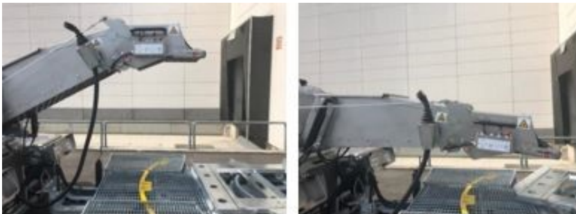
Abbildung 6: Bisher genutztes Fangarm-Modul (Fotos: Gotthart, Verlade GbR)
