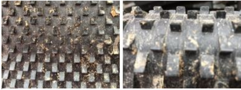
Abbildung 4: Förderbänder der bisher eingesetzten Fangmaschine (Fotos: Gotthart, Verlade GbR)
