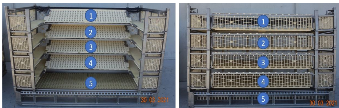
Abbildung 2: Smartstack Container mit geöffneten (links) und geschlossenen Schubladen (rechts) und Nummerierung der Schubladen (Firma Marel, Island) (Foto: Bläske)
