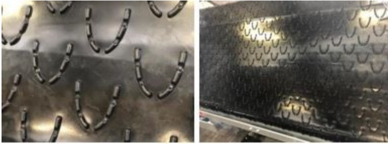
Abbildung 5: Neue verwendete Förderbandstruktur mit multiplen hufeisenförmigen Erhebungen (Fotos: CMC Industries)
