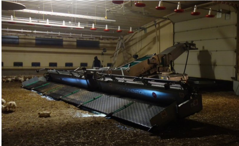
Abbildung 3: Modifizierte CMC Apollo Generation 2 Fangmaschine im Stall (Firma CMC Industries, Italien) (Foto: Bläske)
