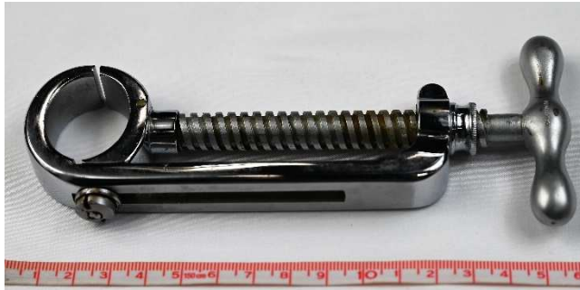
Abbildung 107: Kluppschraube, eine Seite offen; Sammlung Dr. Wentges Kiste 30/8 A, Foto: eigene Aufnahme.
