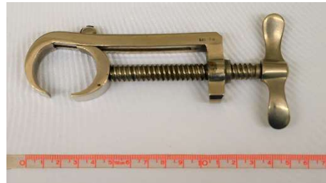
Abbildung 106: Kluppschraube, eine Seite offen, S-förmiger Handgriff; Institutssammlung Kiste rot 44/994, Foto: eigene Aufnahme.
