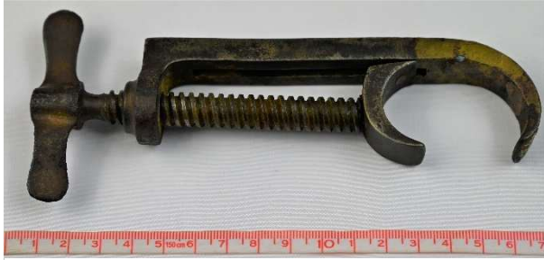
Abbildung 105: Ältere Kluppschraube eine Seite offen, mit S-förmigem Handgriff; Sammlung Dr. Wentges Kiste 30/9, Foto: eigene Aufnahme.
