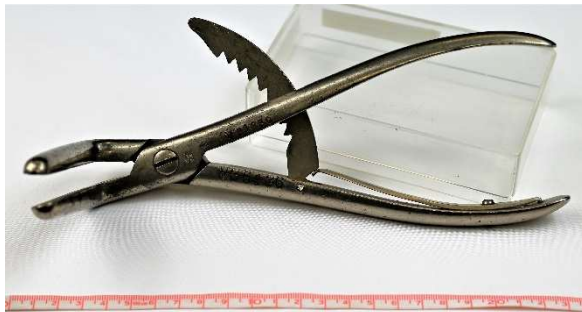
Abbildung 114: Bewegliche Torsionszange, Modell der Berliner Hochschule; Sammlung Dr. Wentges Kiste 26/7 C, Foto: eigene Aufnahme.
