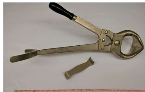
Abbildung 26: Kastrierzange nach Burdizzo mit Kniebügel nach Lienhard und Schraubenschlüssel; Institutssammlung Kiste 25/441, Foto: eigene Aufnahme.
