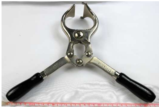
Abbildung 74: Kastrierzange nach Burdizzo mit Cord-Stop, kleines Modell; EHW-Stiftung B11/2, Foto: eigene Aufnahme.
