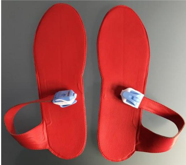
Abb. 7: Drucksensitive Einlegesohlen loadsol® der Firma Novel [44]
