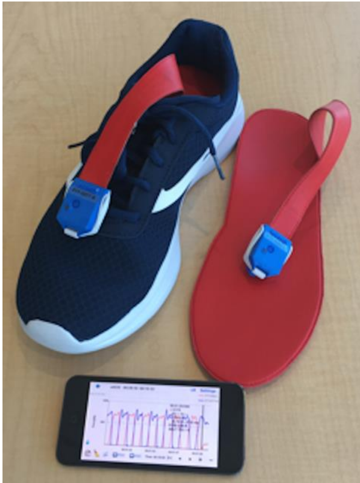
Abbildung 10 zeigt die Loadsol® der Firma Novel, welche als Einlegesohle den Patienten mit nach Hause gegeben wurde. Ein entsprechender ipod touch wurde ebenfalls mitgegeben, um das audiovisuelle Feedback zu Hause im Selbsttraining zu ermöglichen.
