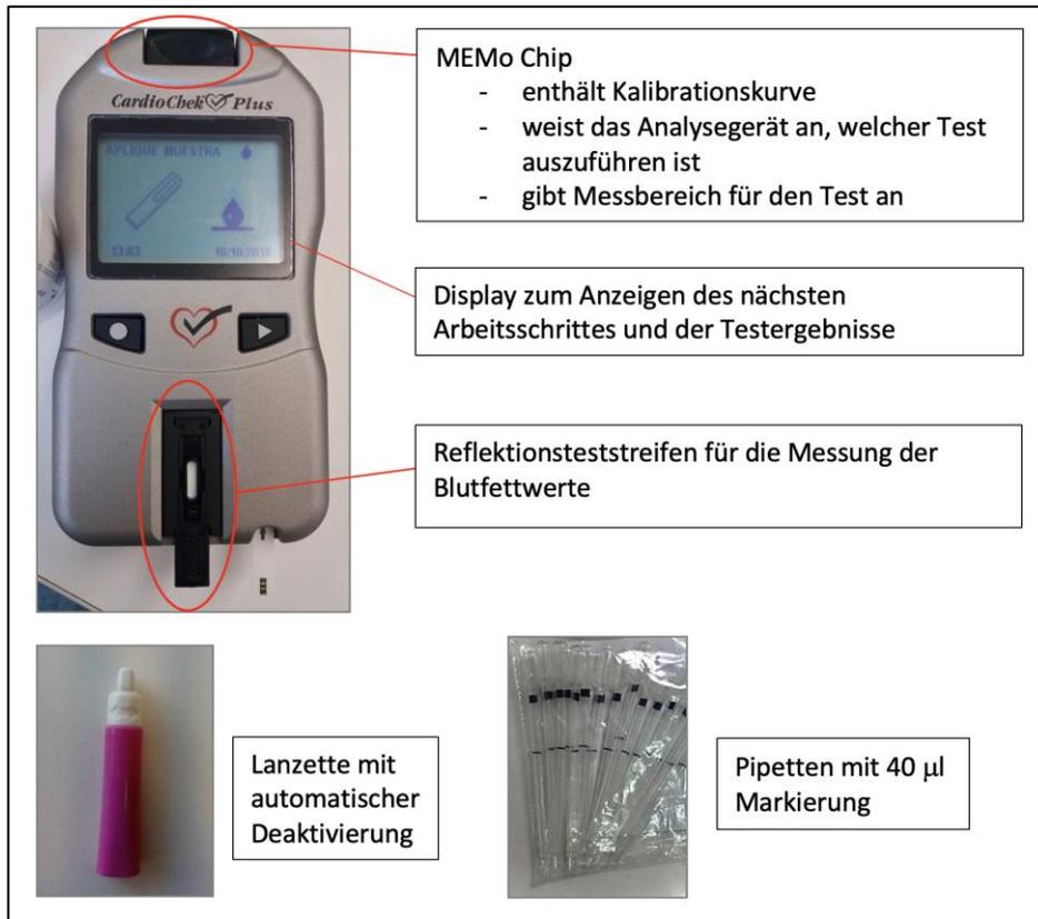
Abbildung 3.4: Benötigtes Material für den Bluttest (außerdem wurden Tupfer, Desinfektionsmittel und Einmalhandschuhe verwendet) (Fotos: Cintya Patricia Saavedra Videla)
