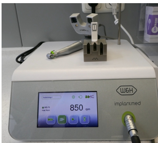
Abb. 17: DENACAM Registrier Block und DENACAM Kamera, positioniert auf dem W&H Chirurgiegerät Implantmed.
