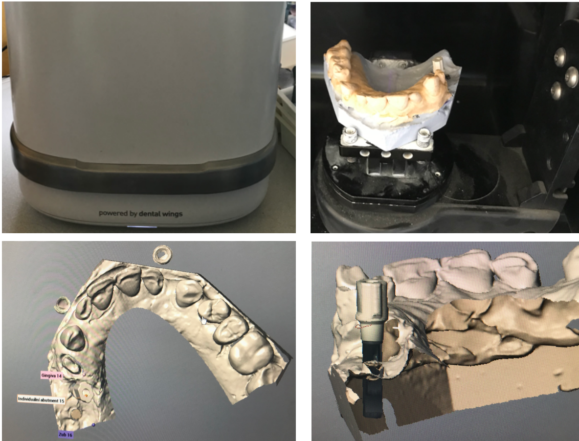
Abb. 28: Optischer 3D Scanner (Dental Wings 3 series scanner) außen (oben links) und innen mit eingesetztem Gipsmodell (oben rechts), STL Scan (unten links) und errechnete Implantatposition (unten rechts).
